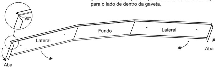
II) Encaixe as abas da gaveta no recorte existente na almofada. Em seguida, encaixe a base na gaveta, de cima para baixo, antes de fixar os parafusos.
